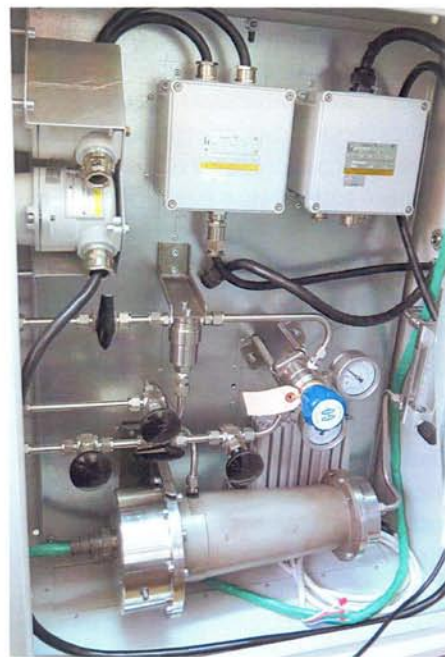
Рис. 2. Фото внутреннего устройства гигрометра ГЛ-02
